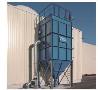
对于大型工业袋式除尘器，除了经典的喷射脉冲清灰外，万迪欧德还采用反向空气技术来清洁滤袋。与传统的压缩空气喷射清灰相比，需要清洁的腔室与气流分离（离线清灰），并用从清洁气体区域获取的工艺空气向后吹灰。除了小型清洁空气风机外，清洁系统仅存在气动或电动挡板。无需喷嘴、阀门或压缩空气罐。特别是在运营支出方面，节省压缩空气是一个真正的成本优势。此外，滤袋不会被压缩空气脉冲过度拉伸，从而延长了使用寿命。
