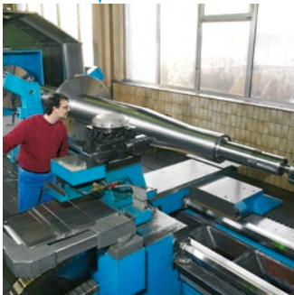
锻造的带法兰盘的轴以及焊接叶轮的最终加工
