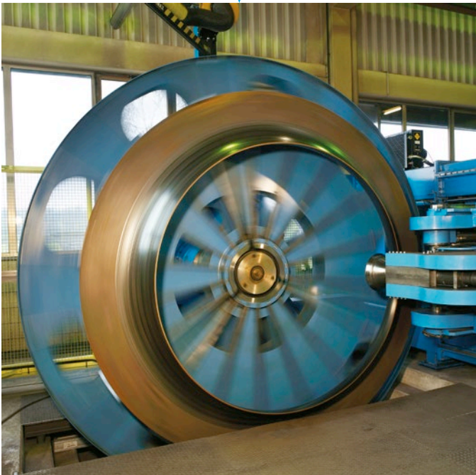
在旋压成型机上 加工直径高达 4.5米的叶轮盘
